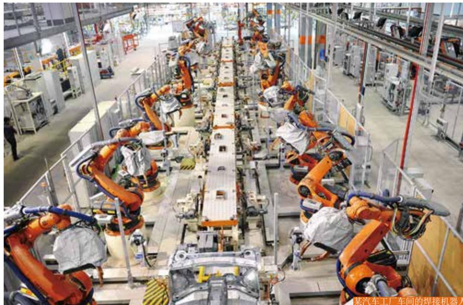
某汽车工厂车间的焊接机器人
