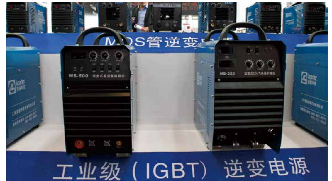
右图：焊接电源（资料图）。与国外现有频率 20kHz 的工业级焊接电源相比，虽然我国的技术有了较大突破，但产业化还有很长的路要走
