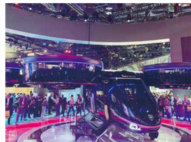
Bell公司展示的混合动力空中出租车Nexus，倾转旋翼、混合动力、垂直起降
