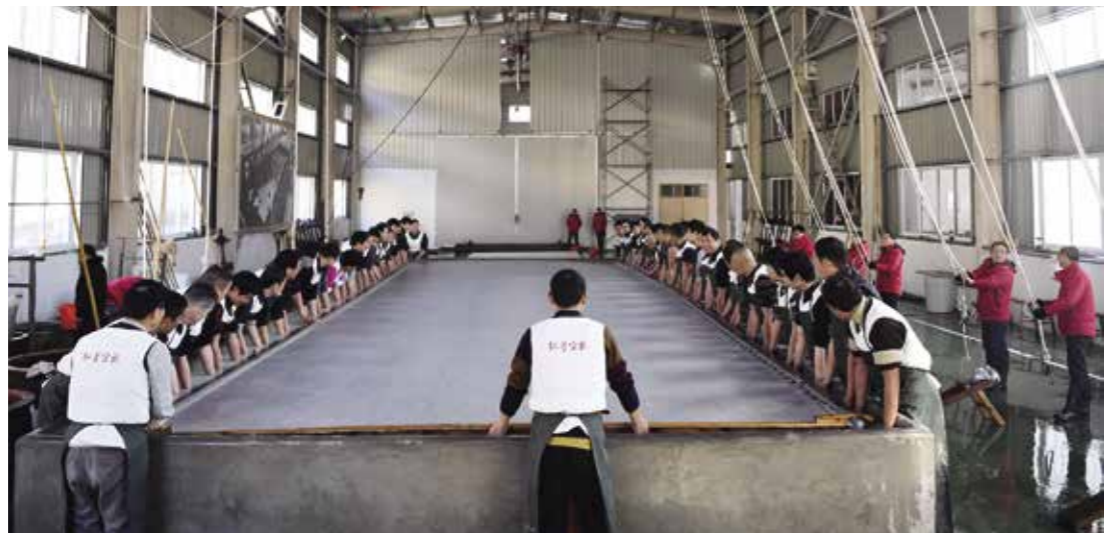
右图：2017年12月21日，中国宣纸股份有限公司再次启动“三丈三超级宣纸”的抄制，“超级宣纸”成品纸尺寸达11米×3.3米，需要捞纸及辅助工52人、晒纸工20人、剪纸工4人配合完成
