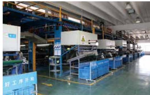
右图：星宇车间内，正在进行手套的浸胶处理
