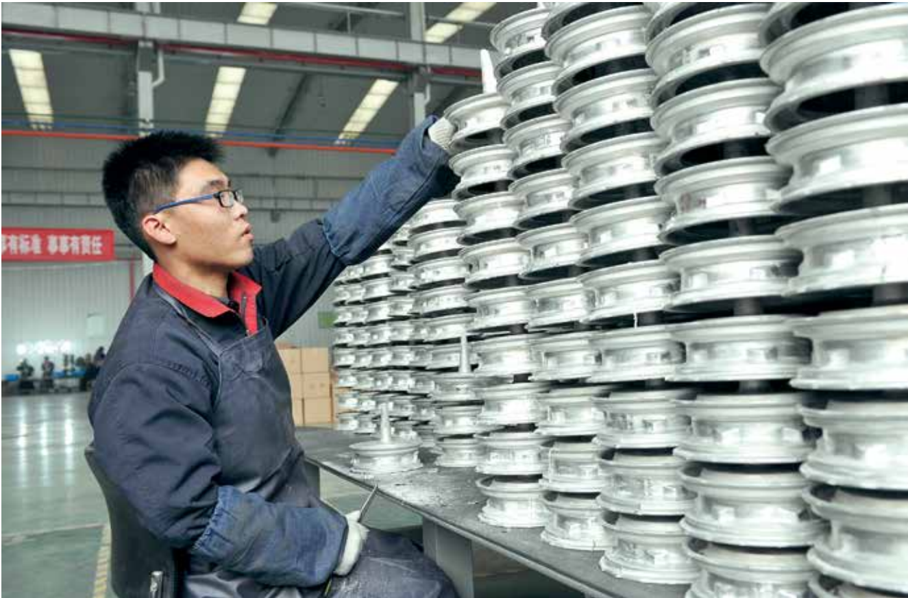
除了常州吉庆生产电机，“九号平衡车”的镁合金轮毂正从山西中德集团汽车轻量化事业部生产车间内被制造出来。中德集团在镁合金等新材料压铸精加工技术上取得了重要突破 @视觉中国
