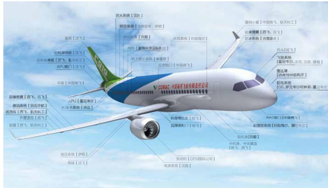
图为C919大型客机的国内外供应商示意图，充分说明集成创新在大制造中日渐普遍
